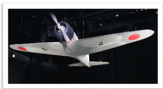
ゼロ戦のプロトタイプ (設計当初はプロペラが2枚構成)
