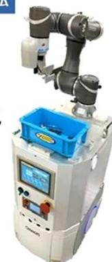
自律走行搬送ロボット (Autonomous Mobile Robot 略称AMR) と協働ロボットで構成された搬送システムです。製造現場で行われている部品の搬送・供給・回収業務の自動化を目指して「デリバリーロボット」を開発致しました。
