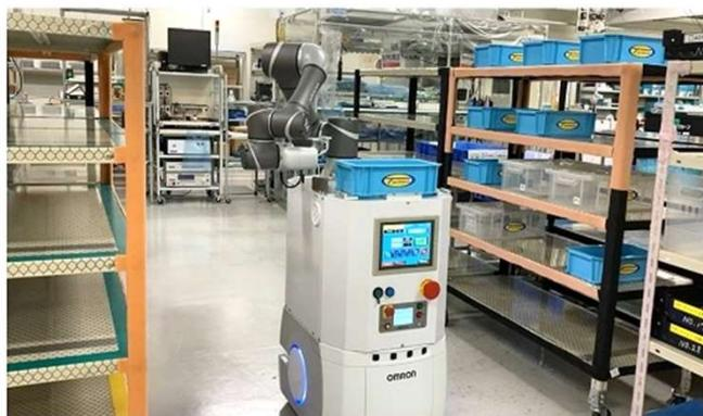
部品供給箱の在荷を確認し、AMRが移動開始します
